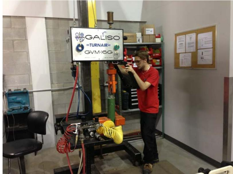
Avant de tester un cylindre on doit d'abord s'assurer de bien le dévisser. Notre appareil de "dévissage" à pression nous a fait passer de l'ère de la massue et de la clé anglaise à celle de la pression contrôlée. Moins de dommages dans les étapes de manipulations permettent d'éviter des coûts additionnels et de prolonger de quelques années votre investissement. On voit ici notre technicien s'assurer de la pression réglementaire à la fermeture d'un cylindre.
