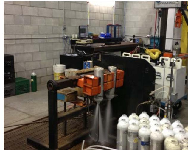
Avant de remplir les cylindres et de les refermer, nous nous assurons que ces derniers sont bien asséchés et exempts de toute impureté. Notre appareil de séchage automatisé permet de nettoyer et de sécher sous pression tous les modèles de cylindre dont nous faisons l'inspection. Sa base pivotante et automatisée facilite l'opération et assure un contrôle d'une qualité supérieure.
