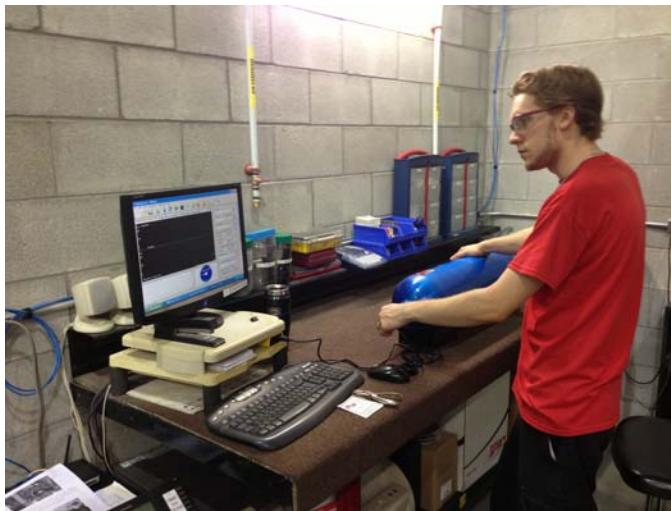
Notre laboratoire est équipé de lampe puissante pour l'inspection visuelle ainsi que de la toute dernière technologie de vérification des collets, l'équipement de type Visual Plus Eddy Current.
