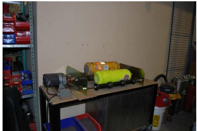
Si les cylindres requièrent un nettoyage ou un sablage interne, nous sommes en mesure d'effectuer ces opérations par jet puissant, injection ou abrasion rotative.
